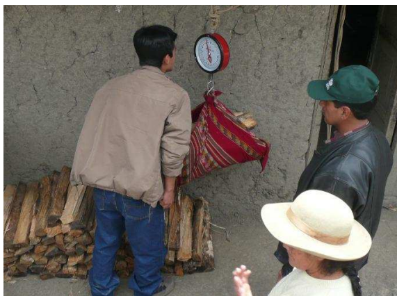
Les campagnes de mesures du combustible - le bois - permettent d'évaluer le nombre de tonnes de carbone réellement évitées – Photo Microsol
