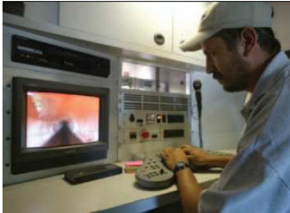
La visite des canalisations par caméra permet de repérer les fuites du réseau les réduisant de 50% – Photo Veolia
